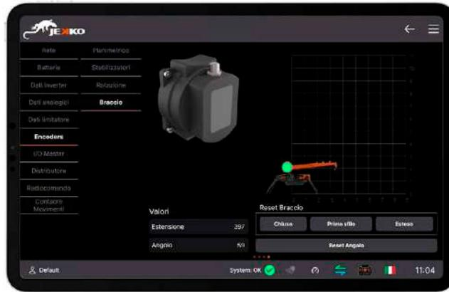
Postventa: La mayoría de los problemas se muestran directamente en la pantalla, evitando tener que conectarse a modos de diagnóstico externos. Lo mismo se aplica también a las calibraciones o cualquier reinicio después de la sustitución de componentes o accesorios, todo se puede configurar a través de la pantalla de la máquina, sin necesidad de intervenciones externas.
